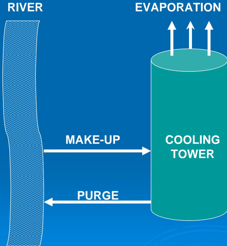
**TYPICAL UK WET COOLING TOWER OPERATES WITH A CONCENTRATION FACTOR OF 1.5 .**
